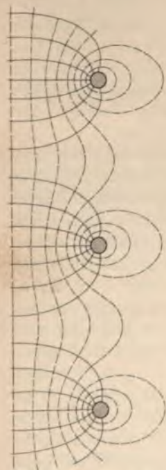
Abb. 25. Schirmwirkung eines Drahtgitters.
